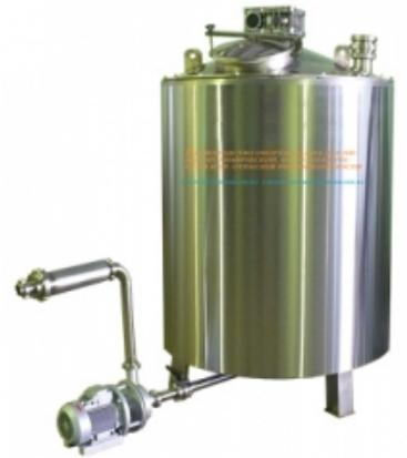
При оснащении вакуумного котла дополнительным оборудованием, сфера его применения значительно расширяется. Вакуумный котел можно будет использовать для перемешивания, диспергирования и гомогенирования продуктов различных отраслей промышленности, включая пищевую и фармацевтическую.
